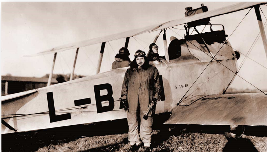
Obrázek 6: Letoun Aero A-14 Brandenburg (přestavěná Hansa Brandenburg C. I) Československých státních aerolinií (L-BARI, v. č. 19).
