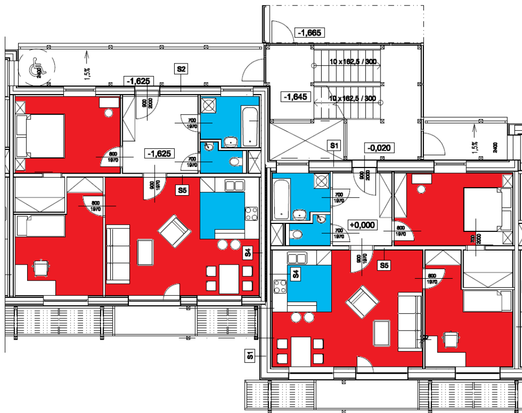
Obr. 10-1 zóny prívodu a odvodu vzduchu jednotlivých bytov
