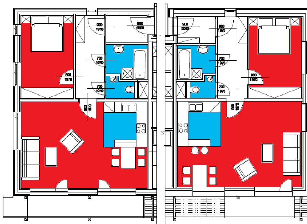
Obr. 10-1 zóny prívodu a odvodu vzduchu jednotlivých bytov
