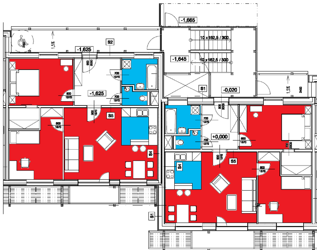
Obr. 10-1 zóny prívodu a odvodu vzduchu jednotlivých bytov
