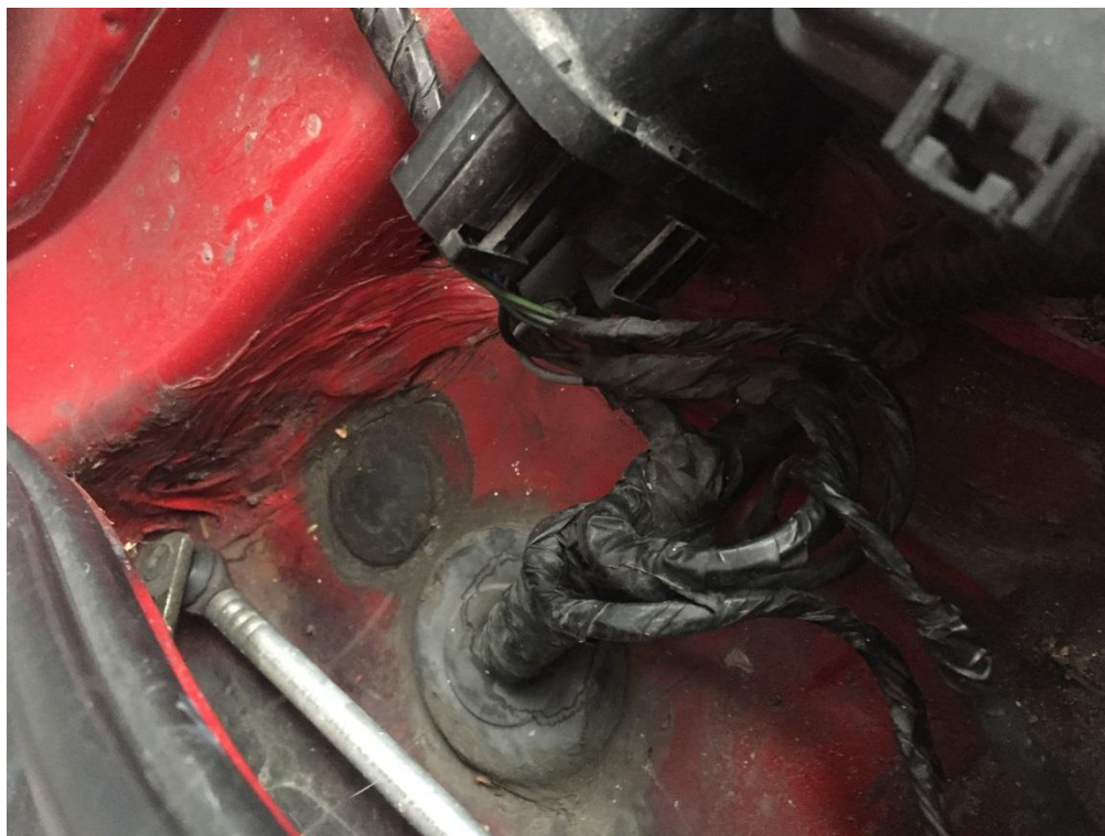
Obrázek 11 - Neodborná oprava po havárii (19)
