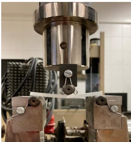
Obr. 22: Třibodová ohybová zkouška s umístěným profilem
