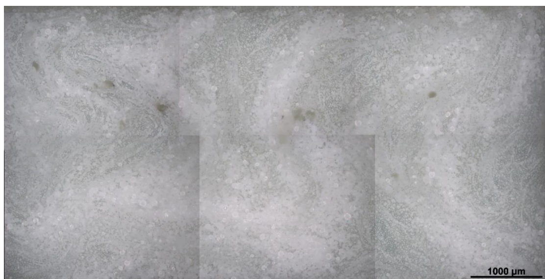
Obr. 30: Snímek struktury kompozitního materiálu na bázi EVE pořízen za použití metody světelné mikroskopie v tmavém poli
