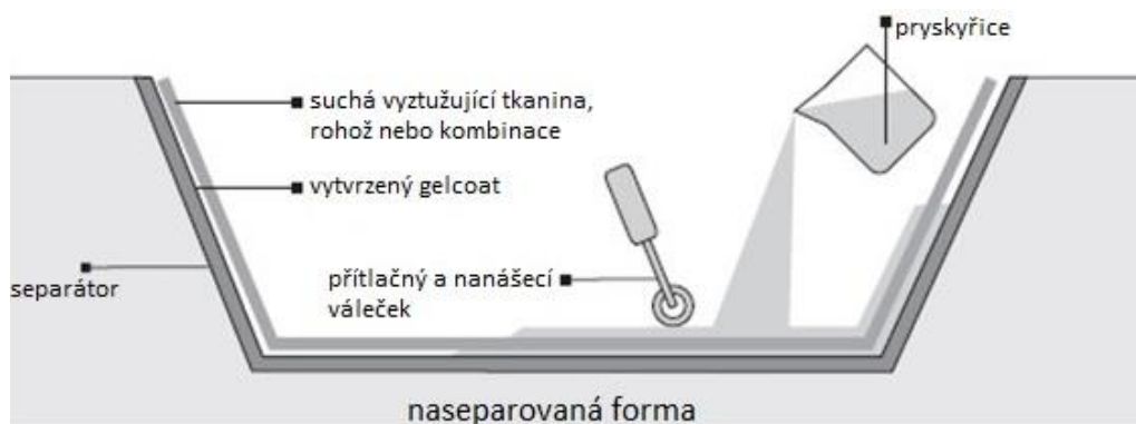
Obr. 13: Schéma ručního kladení [20]
