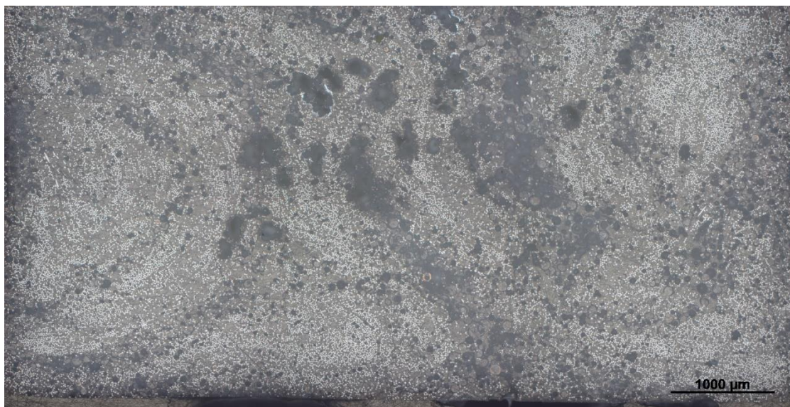
Obr. 31: Snímek struktury kompozitního materiálu na bázi EVE pořízen za použití metody světelné mikroskopie ve světlém poli
