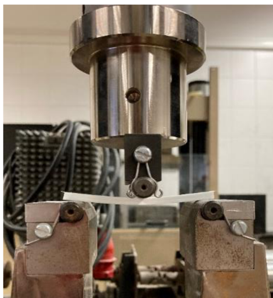
Obr. 22: Třibodová ohybová zkouška s umístěným profilem
