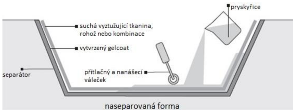
Obr. 13: Schéma ručního kladení [20]
