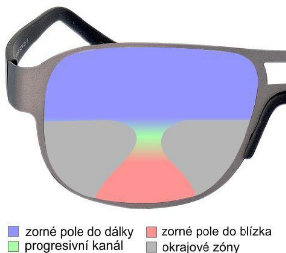
Obrázek 2: Rozmístění jednotlivých segmentů u multifokálních skel [9]
