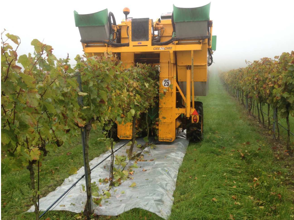
Obr. 5: Měření ztrát propadem na zem
