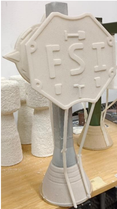
Obr. 72 Schnoucí primární obal.
