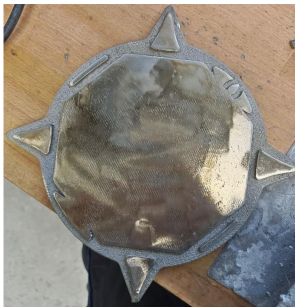
Obr. 92 Přebroušená záda druhého odlitku.
