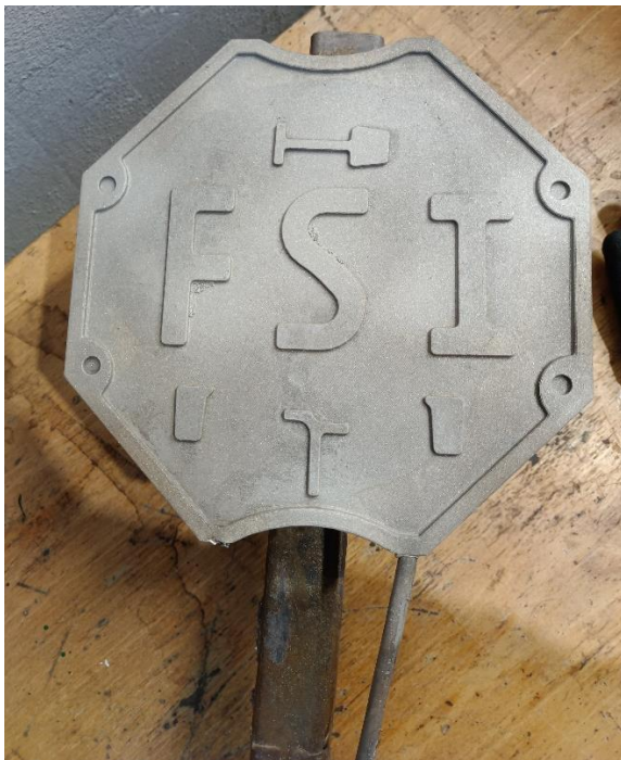
Obr. 89 Opískovaný stromeček z jedné strany.
