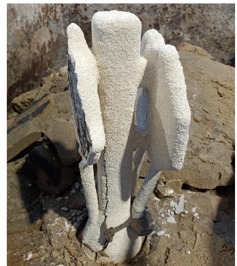
Obr. 87 Skořepina po postupném ochlazování.
