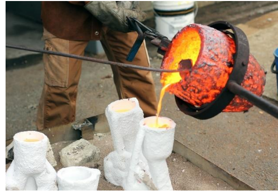
Obr. 17 Odlévání do sádrové formy [29].
