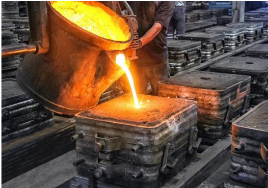
Obr. 16 Lití do pískové formy [28].
