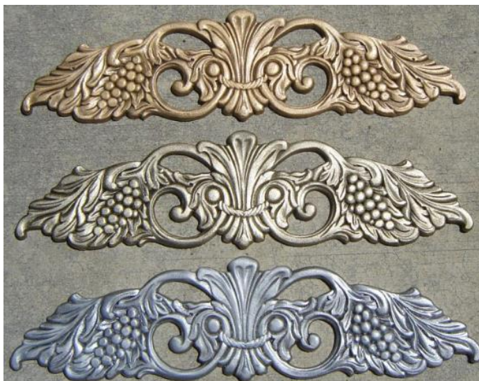
Obr. 59 Čím vyšší je podíl manganu, tím je odlitek světlejší [74].
