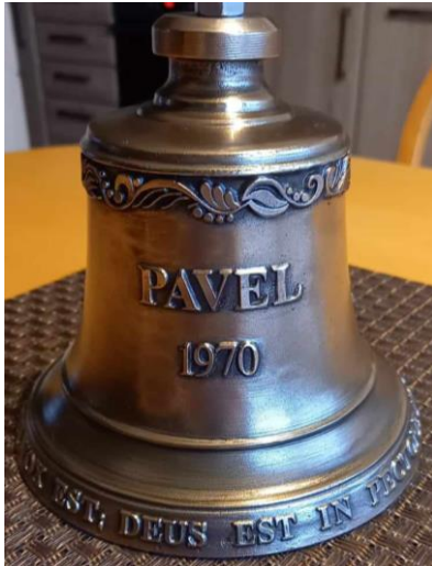
Obr. 44 Odlitek zvonu z CuSn20.
