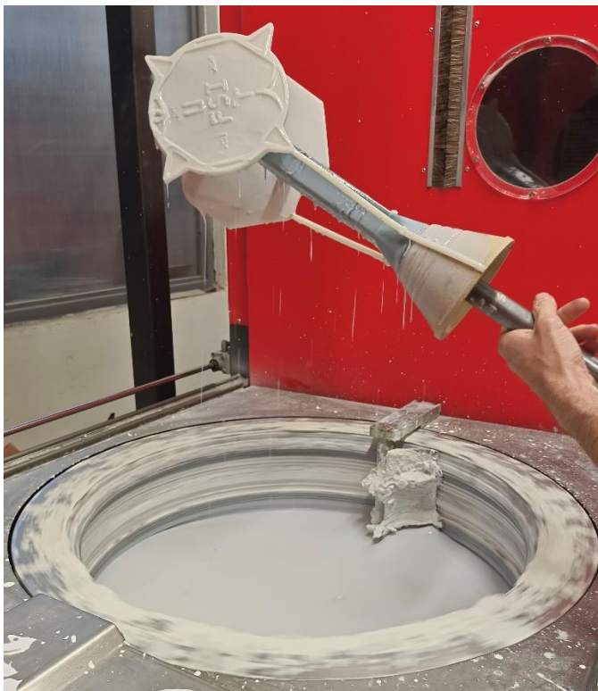
Obr. 70 Ruční obalování v břečce.
