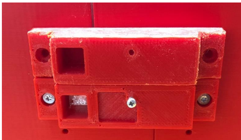
Obrázek 4.7 Spodní část držáku pro senzor vzdálenosti
