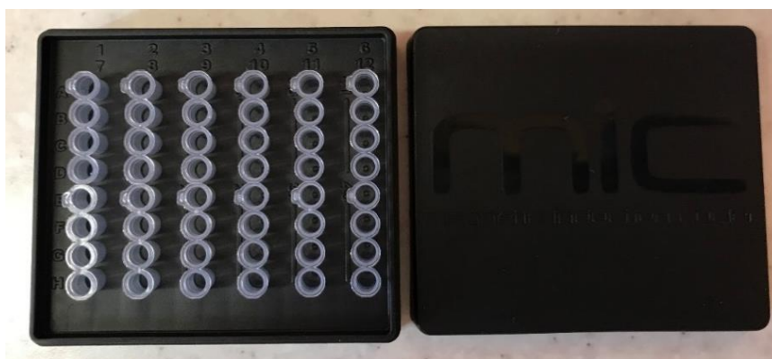
Obrázek 10 – Speciální MIC Tubes mikrozkušavky (vlevo) s ochranným víčkem (vpravo) (Zdroj: vlastní fotografie)
