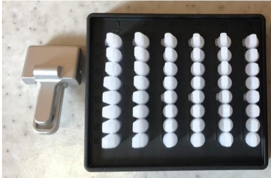
Obrázek 11 – Uzavřené MIC Tubes mikrozkuhavky s izoláty a Master Mix (vpravo), speciální nástavec na uzavírání MIC Tubes (vlevo) (Zdroj: vlastní fotografie)
