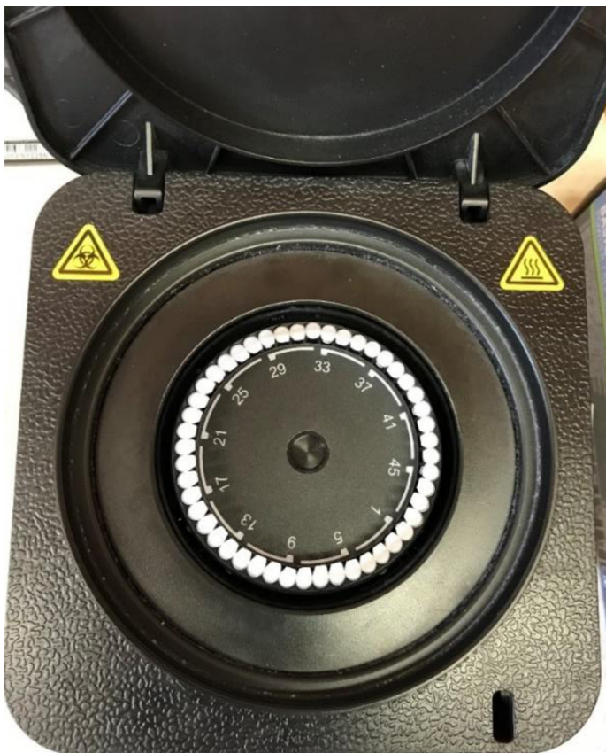
Obrázek 13 – Otevřený detekční přístroj MIC Real Time PCR Cycler (BMS-bio-molecular systems) s uzavřenými MIC Tubes (Zdroj: vlastní fotografie)
