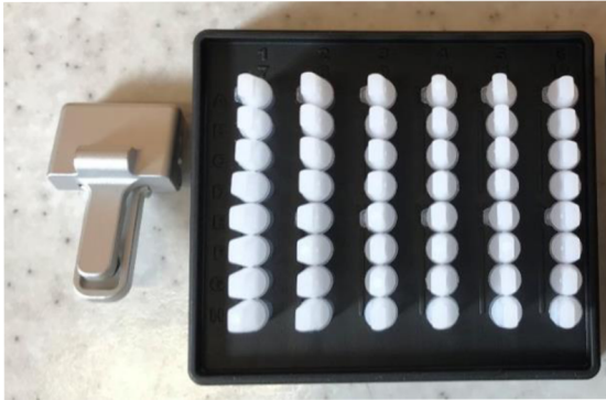
Obrázek 11 – Uzavřené MIC Tubes mikrozkušavky s izoláty a Master Mix (vpravo), speciální nástavec na uzavírání MIC Tubes (vlevo) (Zdroj: vlastní fotografie)
