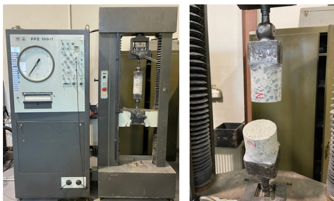
Obrázek 52: Zkouška betonu v prostém tahu – vzorek N2.
