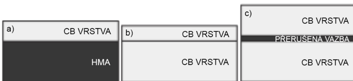
Obrázek 13: Rozdělení betonových převrstvení; a) whitetopping, b) soudržné betonové převrstvení, c) nesoudržné betonové převrstvení [16].
