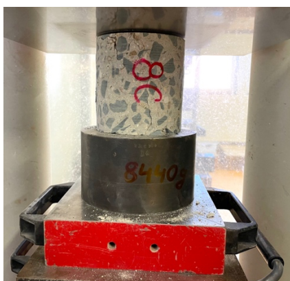
Obrázek 50: Zkouška betonu v tlaku – vzorek 8C/W.
