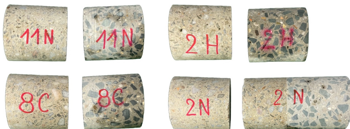
Obrázek 49: Zkušební tělesa připravená z jádrových vývrtů.
