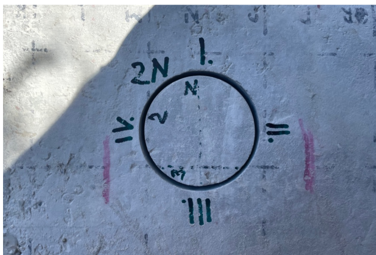
Obrázek 45: Označení směrů I.- IV. u jádrových vývrtů.
