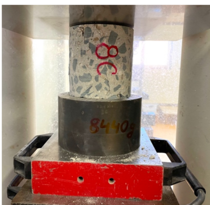
Obrázek 50: Zkouška betonu v tlaku – vzorek 8C/W.
