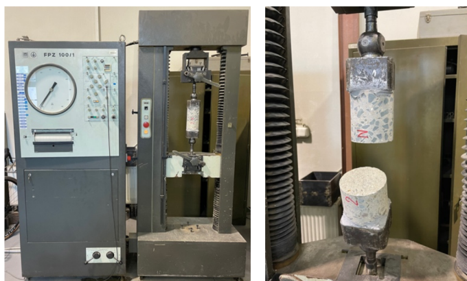
Obrázek 52: Zkouška betonu v prostém tahu – vzorek N2.
