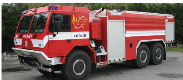
Obr. 4. Hasičské cisterna s kvádrovou nádrží. Bok nádrže je vidět nad zadními koly, mezi přední a zadní roletou.[7]
