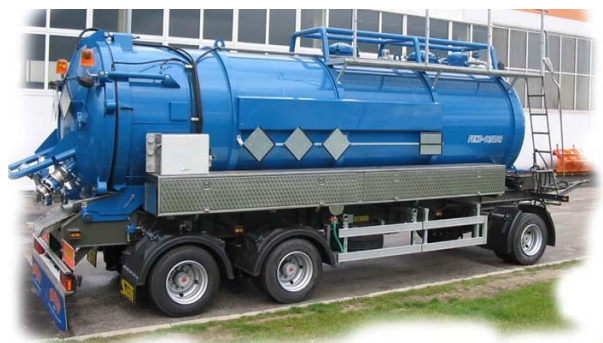
Obr. 5. Jednoplášťový cisternový přívěs pro podtlakové vyčerpávání chemicky znečištěných odpadů.[8]
