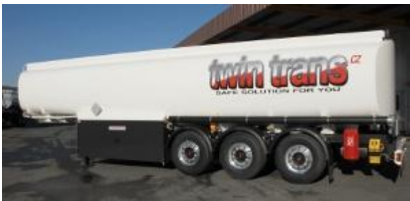
Obr. 2. Cisternový návěs pro přepravu nebezpečných kapalin.[8]
