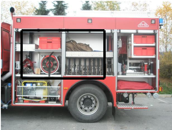
Obr. 6. Hasičská cisterna-účelová nástavba. Umístění dvoukomorové nádrže je naznačeno černým obdelníkem.[7]
