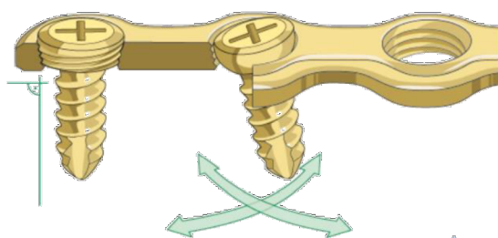
Obrázek 7.6: Řez dlahou umožňující fixaci pomocí „zamykacích“ i standardních šroubů [71]
