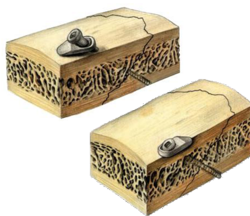
Obrázek 7.12: Příklad použití pomocné adaptivní podložky s kulovým zahloubením [102]
