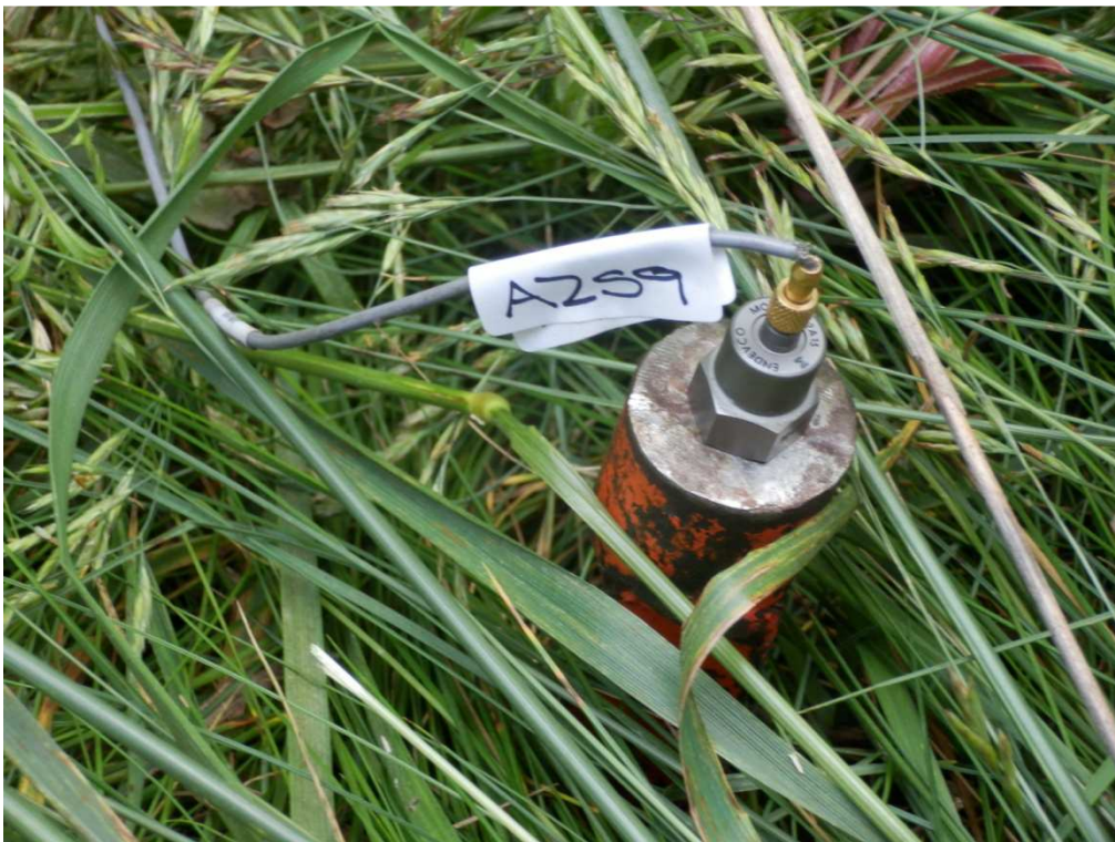
Obr. A.12 Snímač vibrací 7,5 m od osi koľaje
