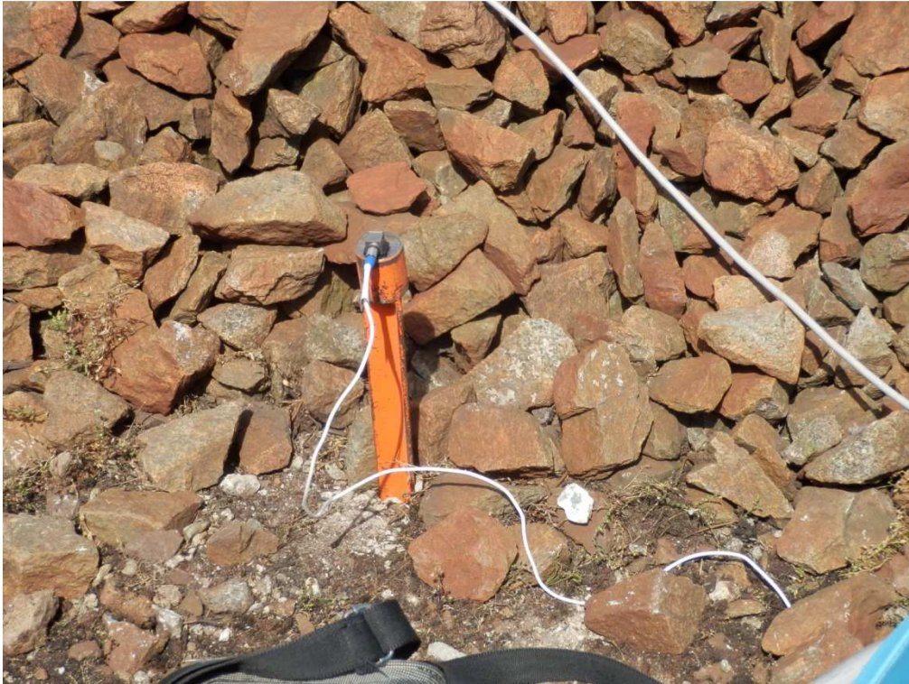
Obr. A.11 Snímač vibrací na hrane koľajového lôžka
