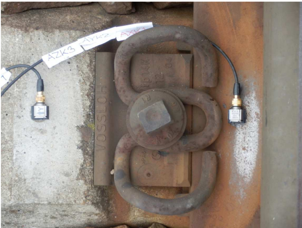
Obr.A.4 Upevnenie KSL - Vossloh W14
