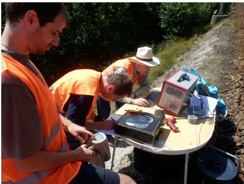
Obr. A.6 Záznam rýchlosti vlaku nameranej radarom
