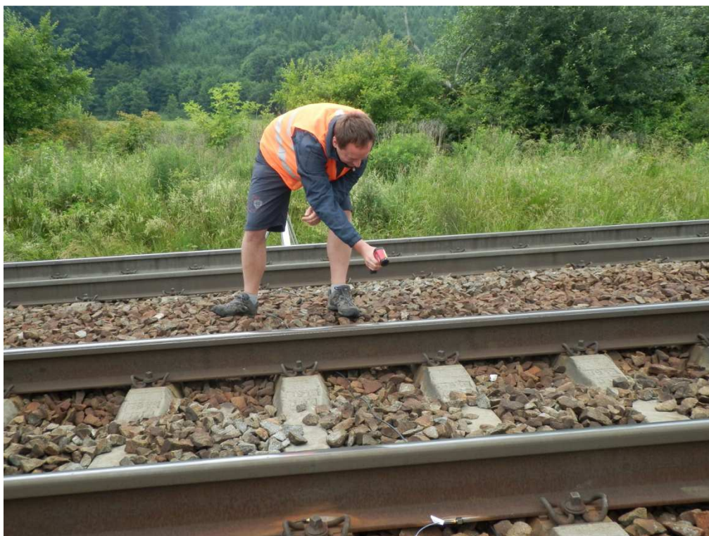
Obr. A.5 Meranie teploty koľajnice infračerveným digigálnym teplomerom
