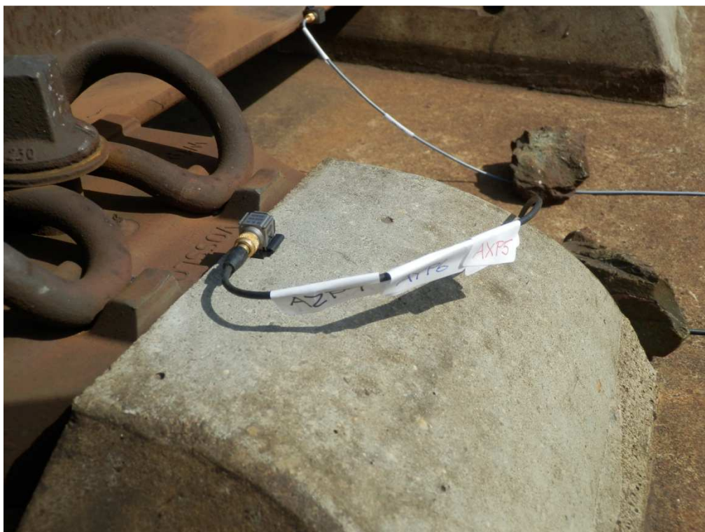
Obr. A.9 Trojosový snímač vibrací na podvale
