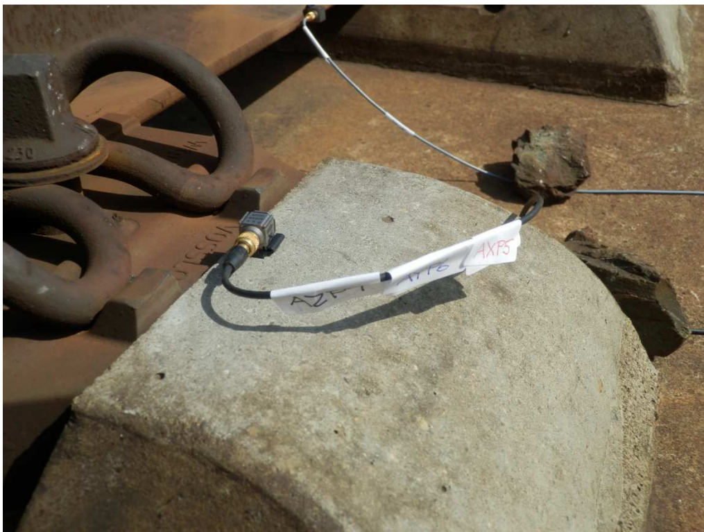
Obr. 4.2 Ukážka snímača zrýchlenia vibrácií
