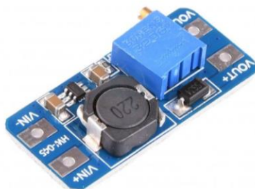
Obr. 23 – Měnič napětí MT3608 [50]
