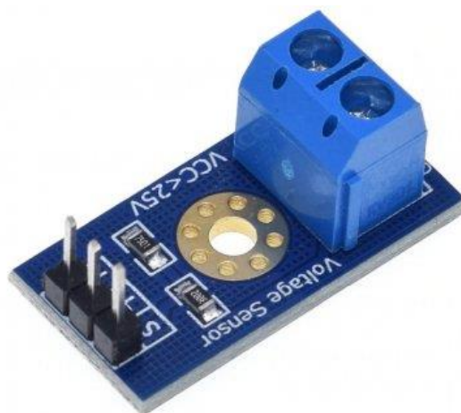
Obr. 24 – Analogový senzor DC napětí [52]
