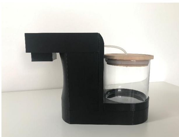
Obr. 31 – Prototyp bezdotykového dávkovače dezinfekce
