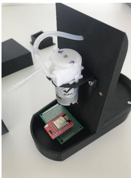
Obr. 30 – Proces sestavování: Upnutí čerpadla a pozice vývojové desky
