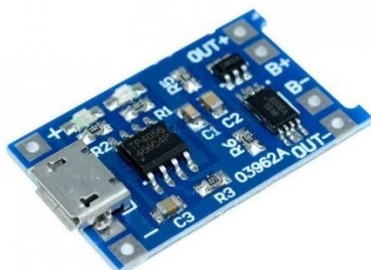
Obr. 19 – Nabíječka Li-ion článku TP4056 s ochranou [48]
