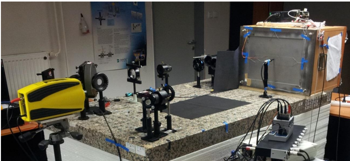
Obr. 5.5: Fotografie experimentálního systému tlumení prostupu hluku na optickém stole s DHI.
