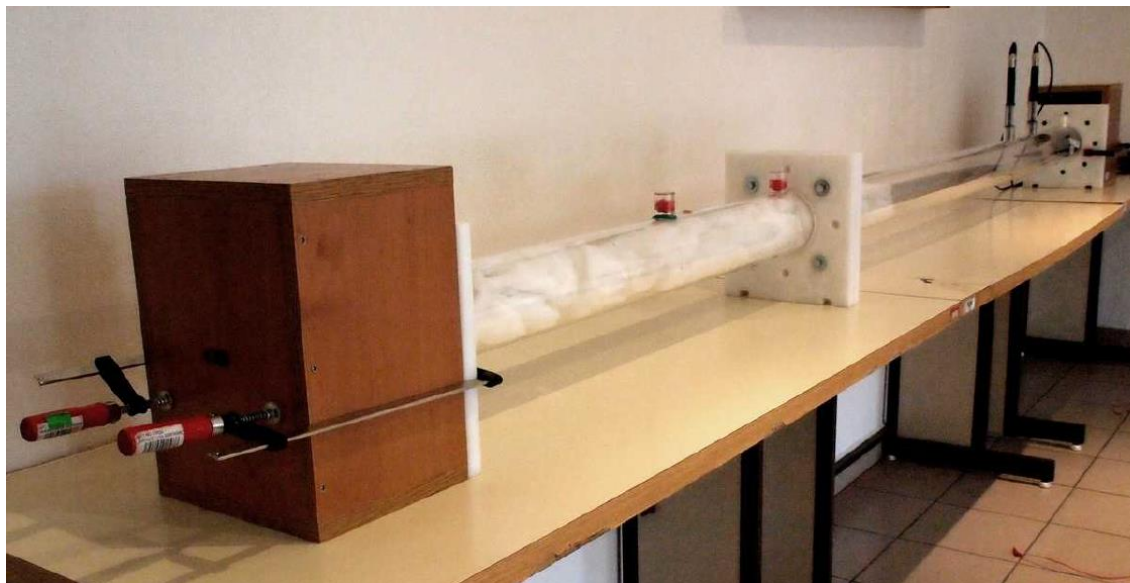
Obr. 5.9: Fotografie exper. systému tlumení odrazu hluku. Převzato z: Černík a Mokřý (2012)
