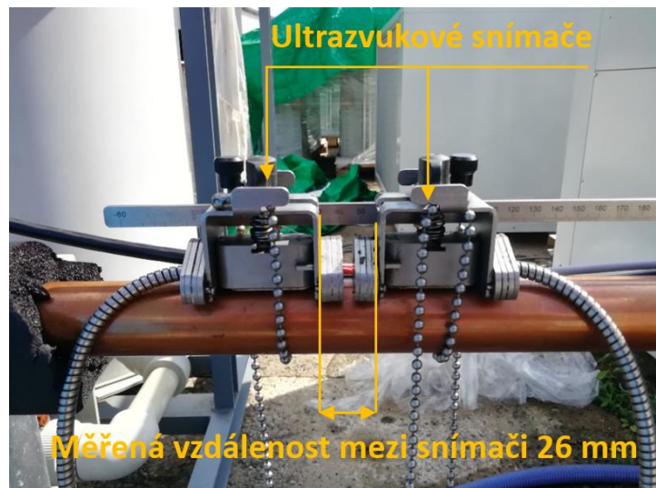
Obrázek 34 Ultrazvukové snímače Flexim Fluxus na jednotce [autor]
