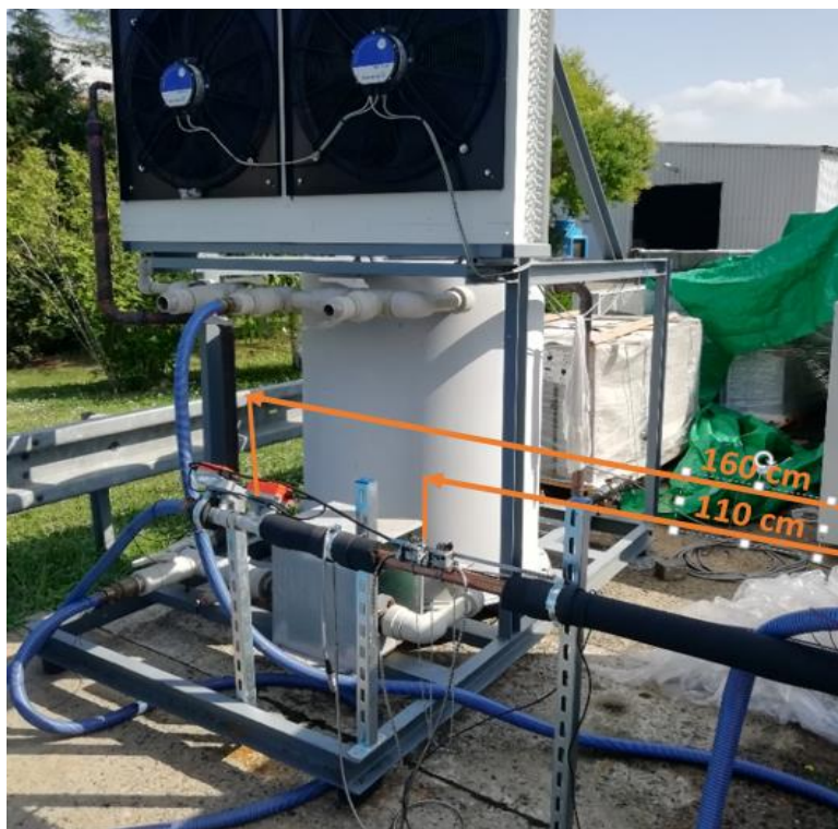
Obrázek 35 Fotografie zkušební jednotky s napojením na maření výkonu včetně průtokoměru a jejich vzdáleností od jednotky [autor]
