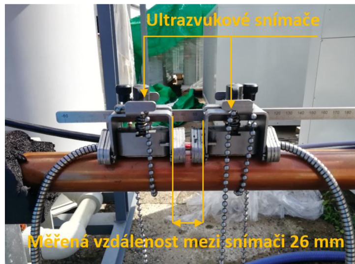
Obrázek 34 Ultrazvukové snímače Flexim Fluxus na jednotce [autor]
