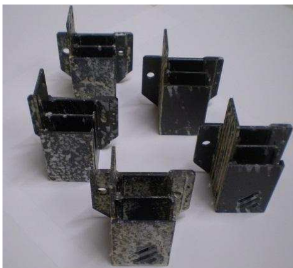
Obr. 4.21: Inovované držáky kartáčů po ukončení korozní zkoušky [18]
