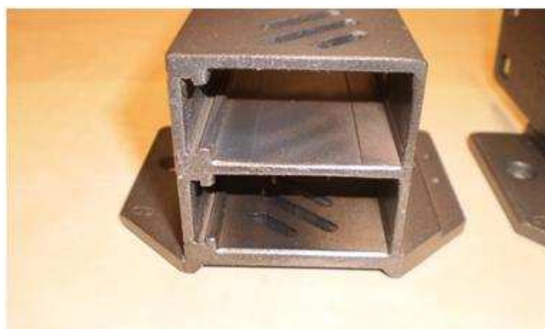
Obr. 4.20: Detail inovovaného držáku kartáče [18]
