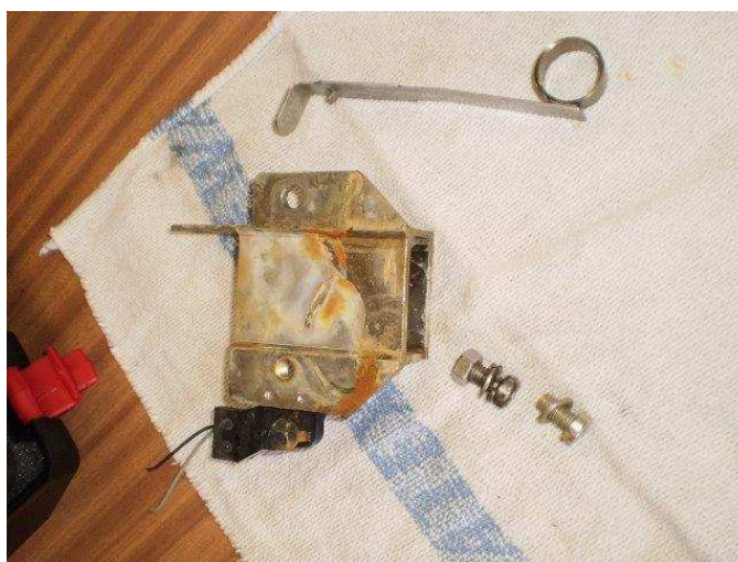
Obr. 4.16: Držák kartáče po ukončení korozní zkoušky [18]
