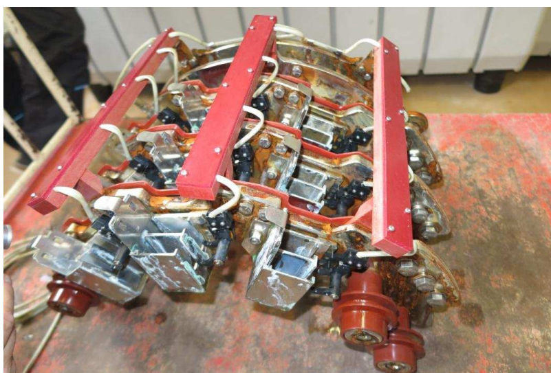
Obr. 4.14: Znárodnění stavu původního sběracího ústrojí po ukončení korozní zkoušky – pohled shora [18]
