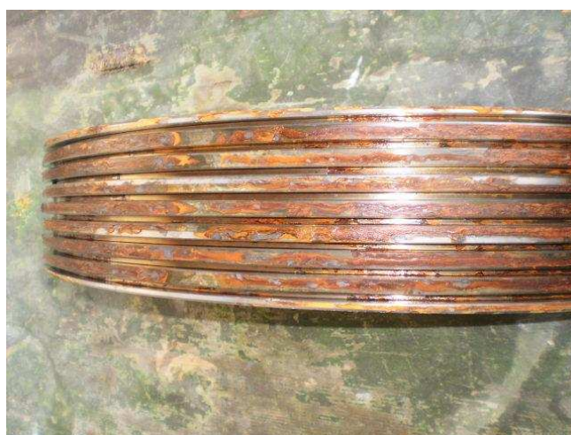
Obr. 4.17: Detail vnějšího povrchu kroužku po ukončení korozní zkoušky [18]
