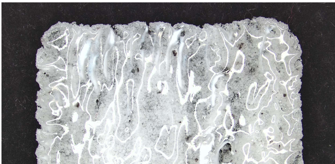
Obrázek 52: Čtvercová destička slinutá působením \text{CO}_2 laseru na pískové lože metodou SLM v rozměru 1 x 1 cm.
