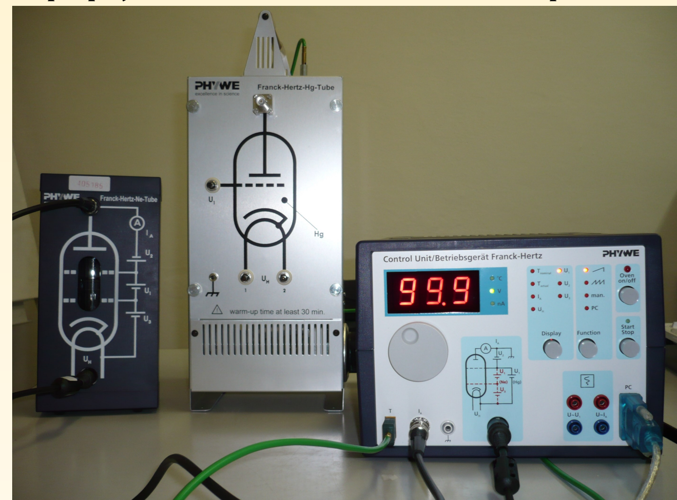
Obr. 4: F-H aparatura s neonovou trubicí vlevo, rtuťovou uprostřed a řídicí jednotkou vlevo.
