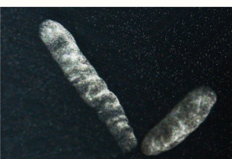
Obr. 11: alfa částice z rozpadu: ^{220}\text{Rn} na ^{216}\text{Po} a jeho následným rozpadem na ^{212}\text{Pb} .
