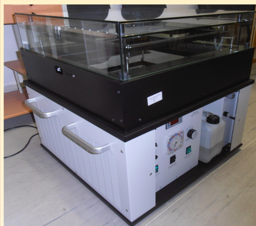
Obr. 2: Difúzní mlžná komora Phywe (vlevo) a její příčný řez s popisem (vpravo). [Phywe, P2520400, nedatováno]
