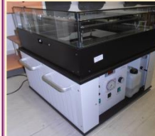
Obr. 2: Difúzní mlžná komora Phyeve (vlevo) a její příčný řez s popisem (vpravo). [Phyeve, P2520400, nedatováno]
