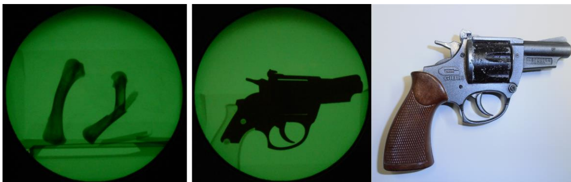
Obrázek 4.4: Vlevo: celá a zlomená kuřecí kost v krabici simulující lidské tělo, vpravo: pistolka v malém zavazadle pod rentgenem a ve skutečnosti.
