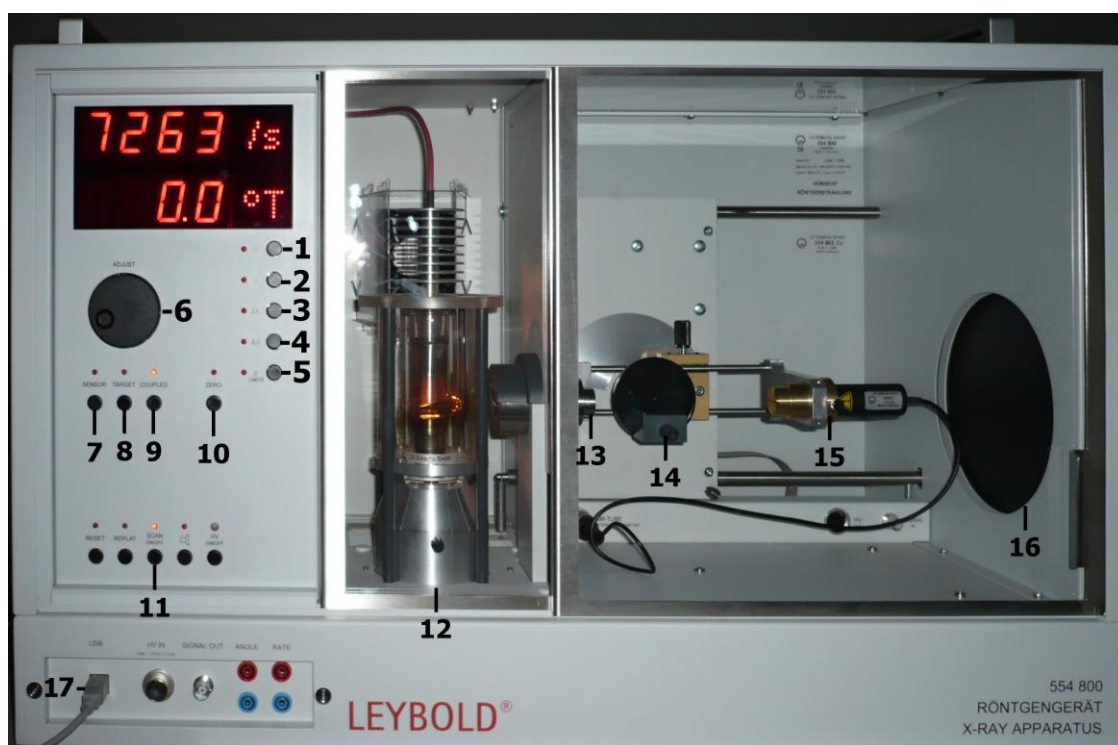
Obrázek 4.1: Rentgenová komora, 1 – nastavení napětí, 2 – nastavení proudu, 3 – nastavení časového intervalu, 4 – nastavení krokování úhlu pootočení, 5 – nastavení maximálního úhlu otočení, 6 – otočné tlačítko pro nastavení konkrétních hodnot, 7 – ovládání sensoru (15), 8 – ovládání terčíku (14), 9 – společné ovládání sensoru (15) a terčíku (14), 10 – nulovací tlačítko, 11 – zapínací a vypínací tlačítko, 12 – Cu rentgenka, 13 – kolimátor, 14 – terčík pro uchycení krystalu, 15 – sensor - G-M trubice, 16 – obrazovka, 17 – konektor k PC.
