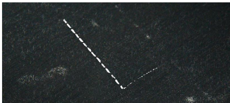
Obrázek 6.8: Zachycený rozpad mionu (ze shora letící mion, vpravo letící produkt rozpadu elektron).
