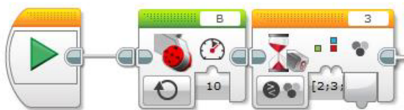
Obrázek 32: Vytvořený blok pro posunutí barevné pomůcky pod senzor
