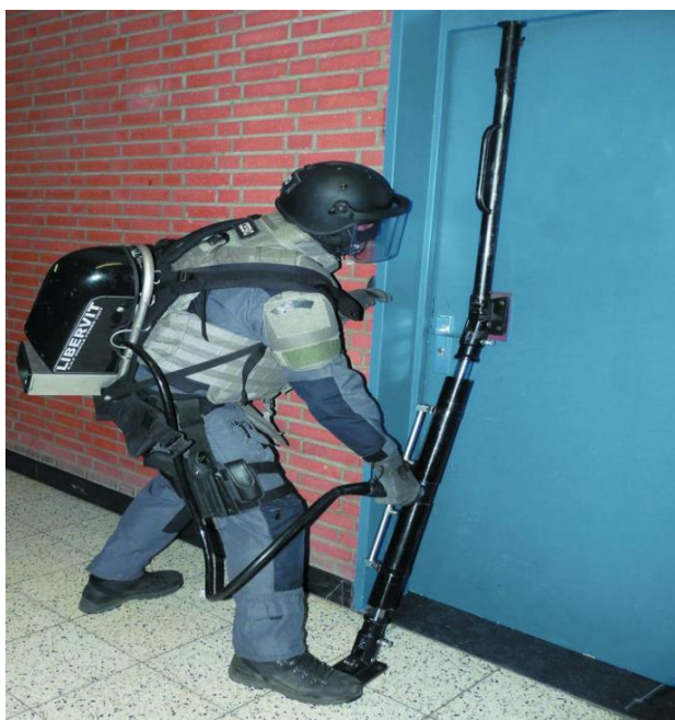
Obrázek 9: Hydraulický systém Door Raider. Zdroj 31
