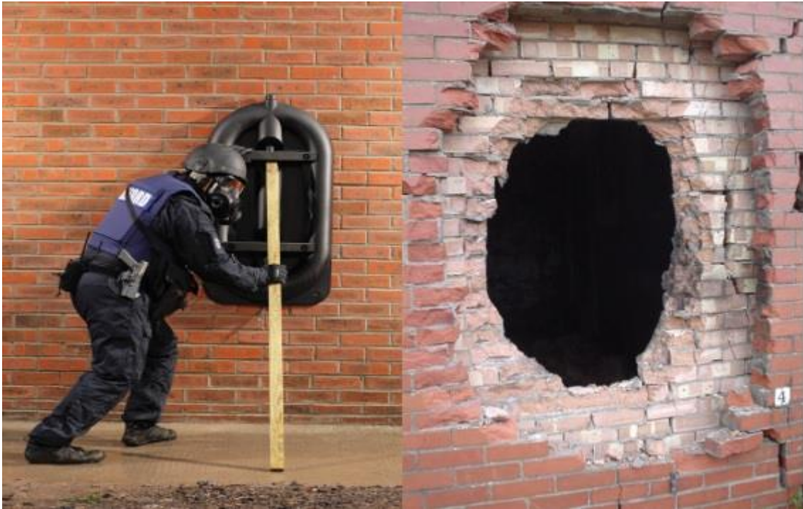
Obrázek 11: Nosič nálože „Gatecrasher Mk 4“ před a po použití na zed'. Zdroj 35
