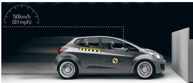
obr. 3-4 Plný čelní náraz do pevné bariéry [7]
