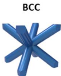
obr. 4-5 Základní mřížka mikro-prutové struktury BCC [25]
