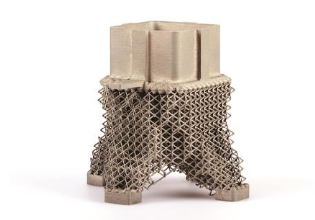
obr. 1-2 Použití mikro-prutové struktury vyrobené metodou SLM [4]
