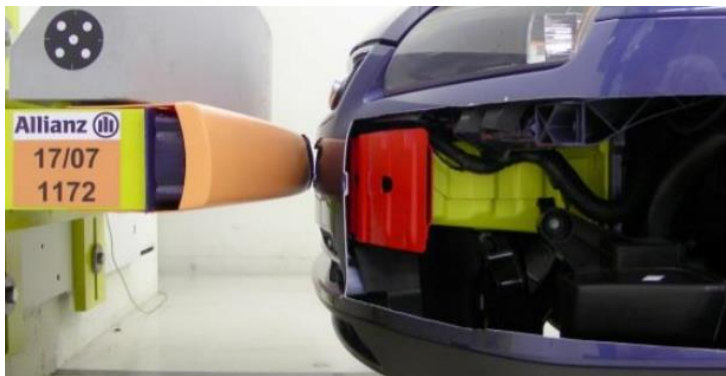
obr. 3-10 Čtyřboký deformační člen s prolisy [10]
