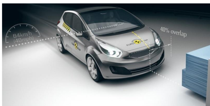
obr. 3-3 Částečný čelní náraz do deformovatelné bariéry [6]
