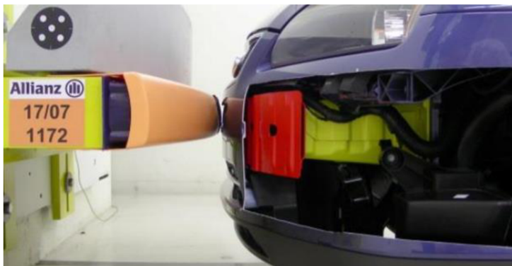
obr. 3-10 Čtyřboký deformační člen s prolisy [10]
