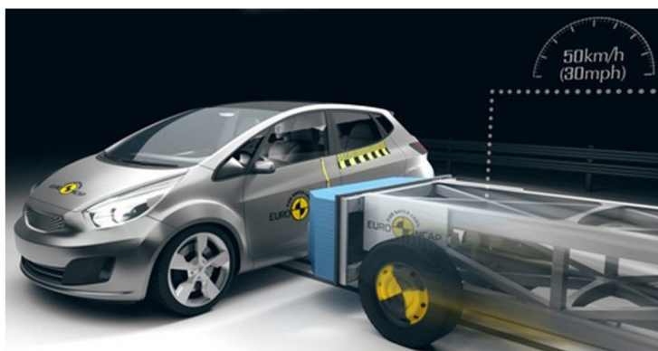
obr. 3-5 Boční náraz vozu do deformovatelné bariéry [8]
