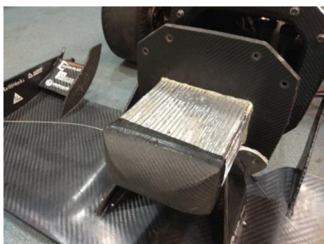
obr. 3-18 Deformační člen využíváný týmem TU Brno Racing na voze Dragon 9
