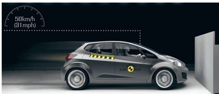
obr. 3-4 Plný čelní náraz do pevné bariéry [7]
