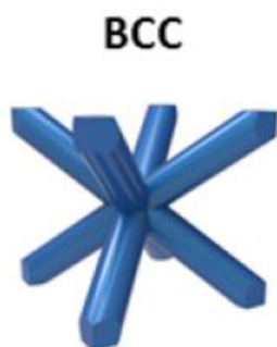
obr. 4-5 Základní mřížka mikro-prutové struktury BCC [25]
