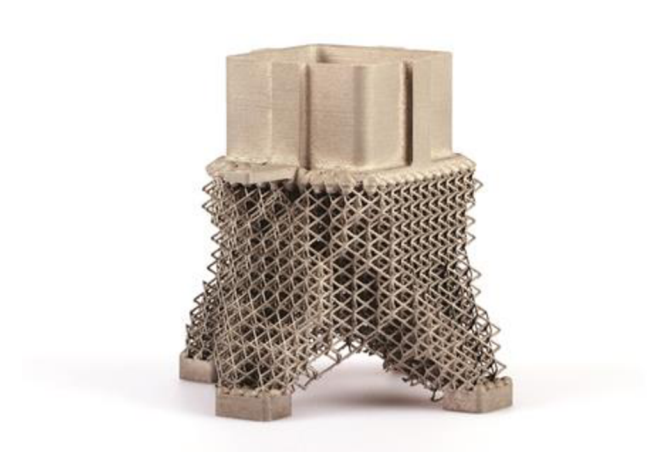
obr. 1-2 Použití mikro-prutové struktury vyrobené metodou SLM [4]
