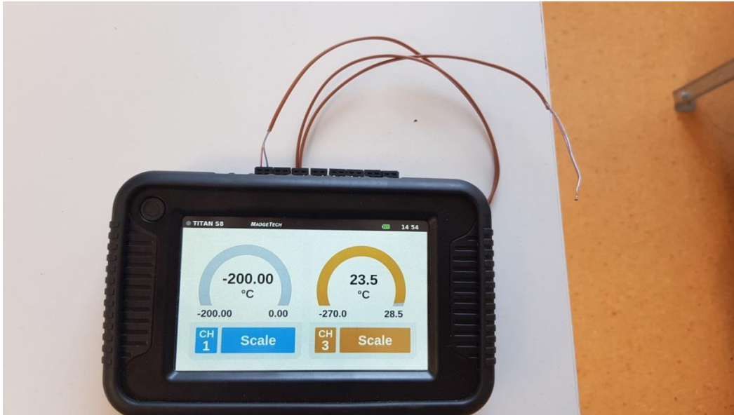
Obr. 24 Použitý termočlánok typu T s digitálnym displejom.
