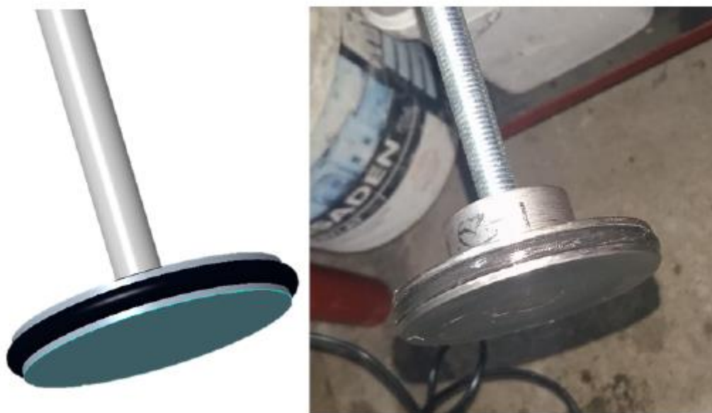
Obr.19 Model a skutočný vyrobený piest [25]
