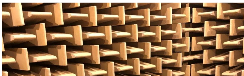
Obr. 5 – Typický tvar obkladu stěn bezdozvukové komory
