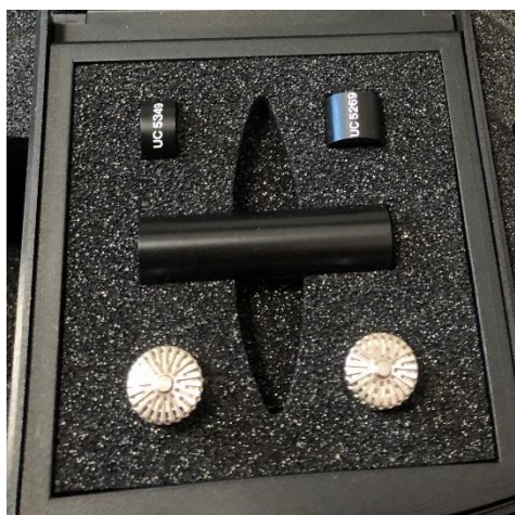
Obr. 4 – Mikrofonní pár a spacer do intenzitní sondy od firmy Brüel & Kjaer
