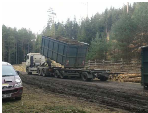
Obrázek č. 3 – Kontejner se štěpkou při nakládání na přívěs nákladního automobilu
