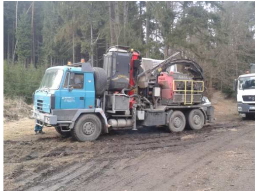
Obrázek č. 1 – Štěpkovač na podvozku nákladního automobilu Tatra
