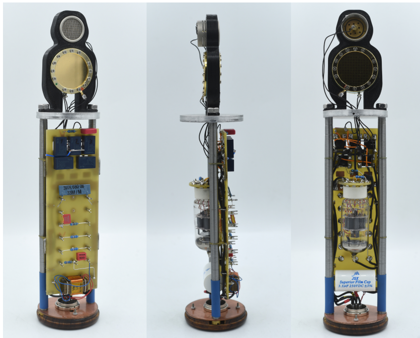
Obr. 4.3: Vnitřní konstrukce mikrofónu z různých úhlů
