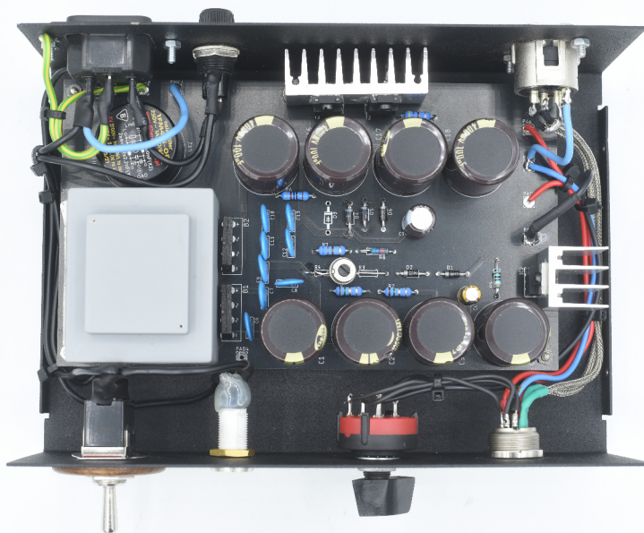
Obr. 4.2: Pohled do vnitřku napájecího zdroje
