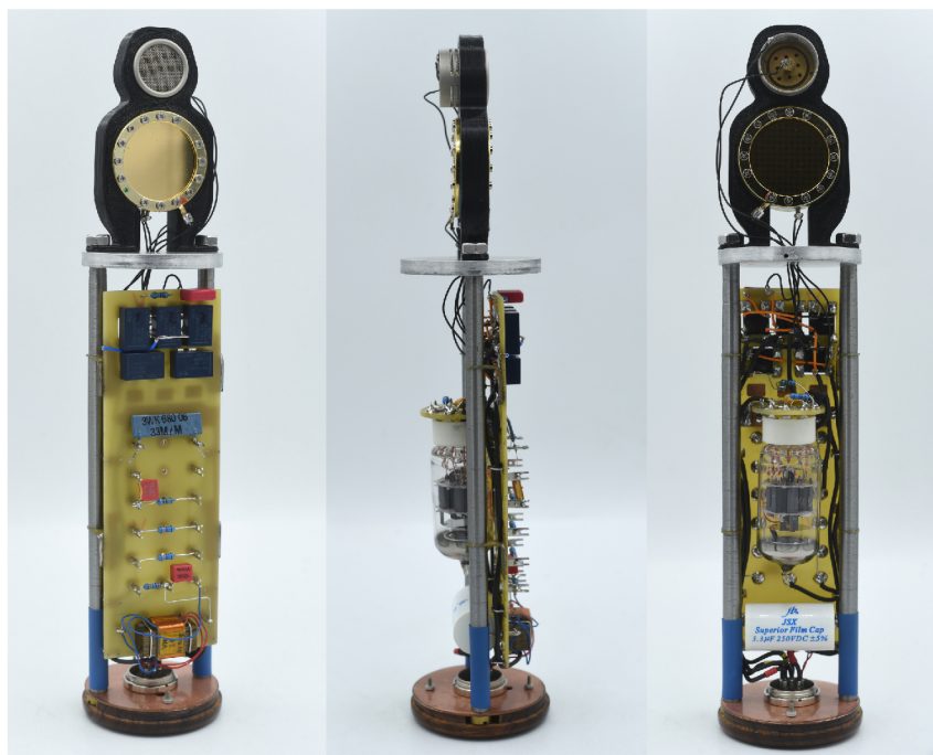
Obr. 4.3: Vnitřní konstrukce mikrofону z různých úhlů
