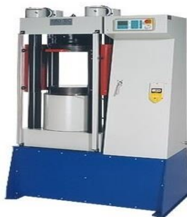
d) pěchovací zkouška
