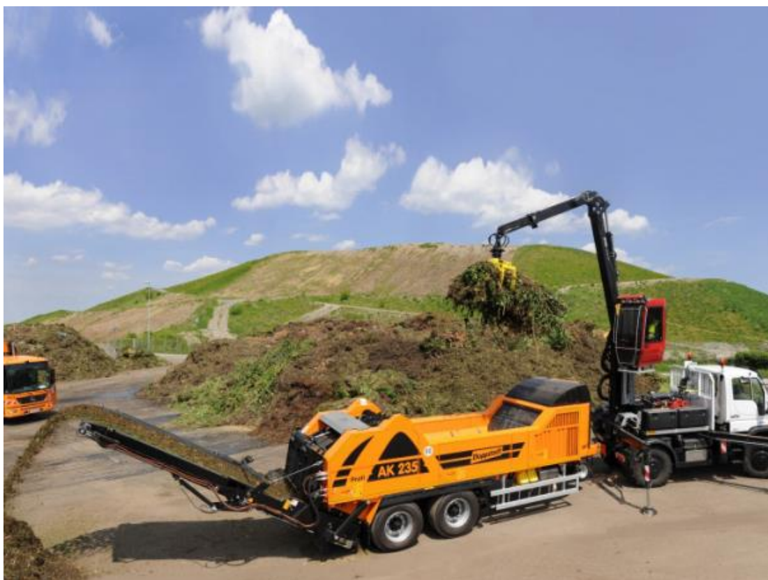
Obrázek 10 Drtič Doppstadt AK 235 využívaný na kompostárně A
