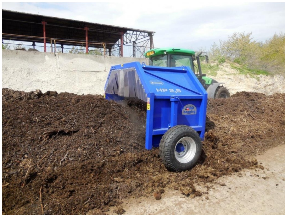
Obrázek 11 Překopávač HP 2,5 využívaný na kompostárně A
