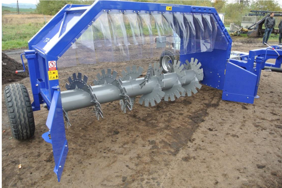
Obrázek 9 Překopávač kompostu, traktorem tažený
