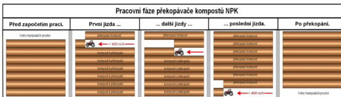
Obrázek 21 Pracovní fáze překopávače NPK 250
