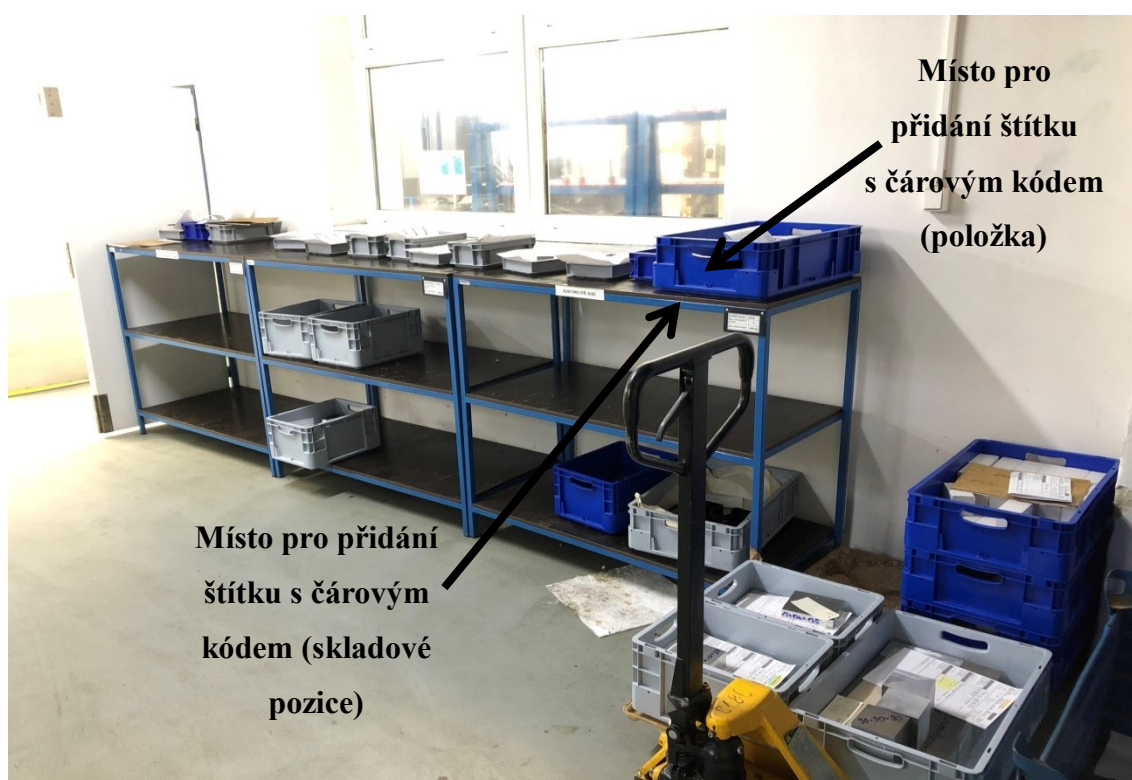
Obr. 4. 1 Příklad označení stávajících regálů a přepravek
