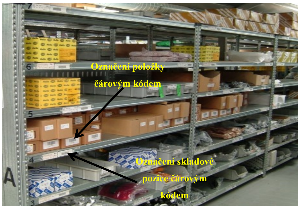
Obr. 3. 4 Příklad označení regálů čárovými kódy
