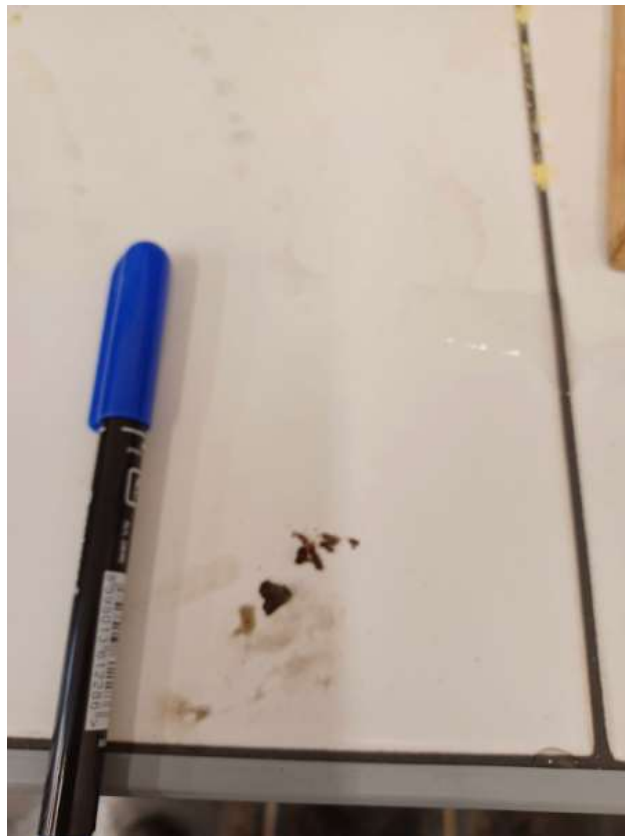
Obr. 40 Úlomky rzi a čerpadla v laboratoři
