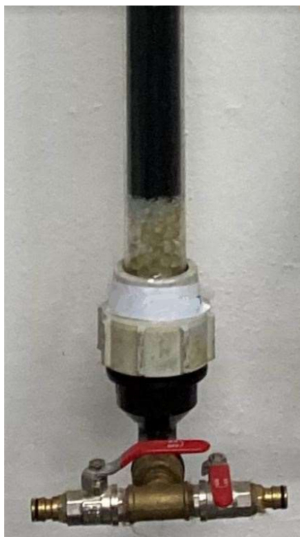
Obr. 23 Drenážní vrstva v koloně [autor]
