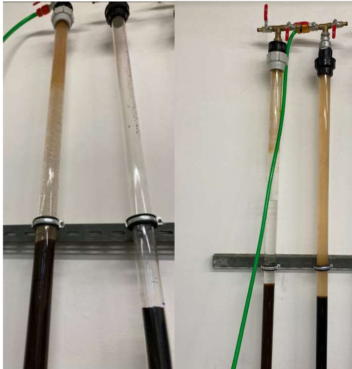
Obr. 24 Propírání adsorbentů [autor]
