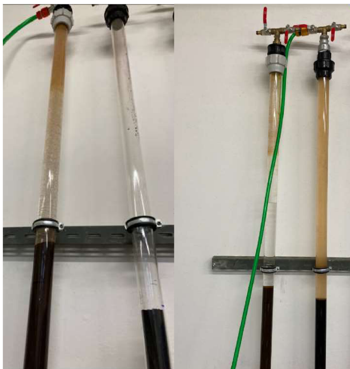
Obr. 24 Propírání adsorbentů [autor]
