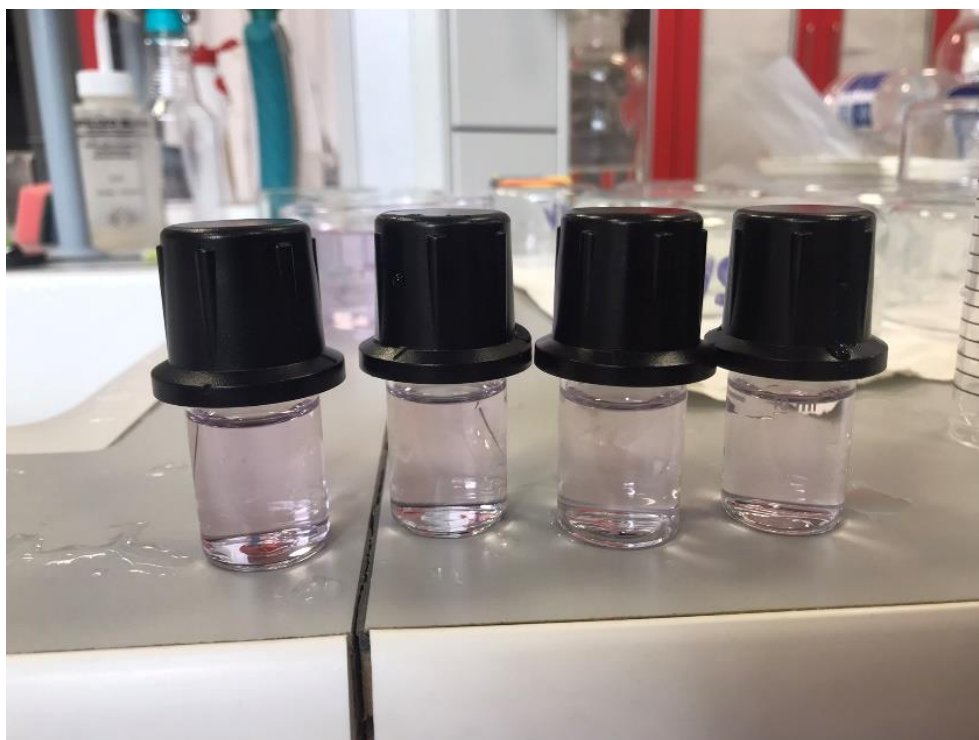
Obrázek 7 Znázorňuje působení reagentu pro stanovení mědi z odebraných vzorků, jehož účinek se projevuje zružováním vody ve skleněné lahvičce
