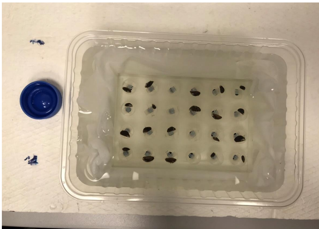
Obrázek 2 Ukazuje skleněnou destičku ponořenou v destilované vodě, vložené stopery ve všech komůrkách a mlže Dreissena polymorpha z expozice v určených komůrkách. K porovnání velikosti bylo použito plastové víčko od 50 ml zkumavky
