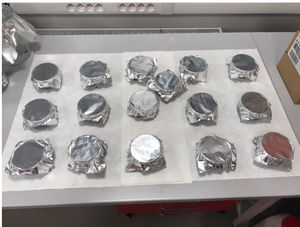
Obrázek 5 Znáznorňuje podobu probíhající expozice a způsob zakrytí krystalizačních misek pomocí hliníkové fólie
