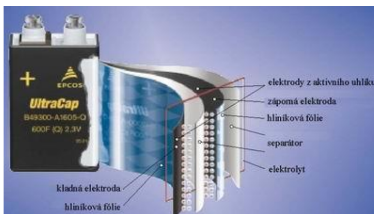
Obr. 7: Složení superkondenzátoru
