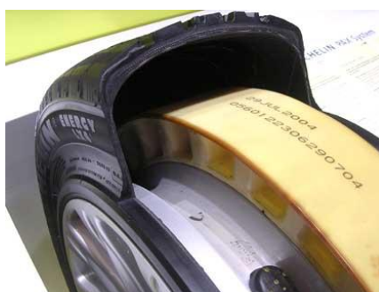
Obr. 32: Systém PAX na ráfku vozidla [74]
