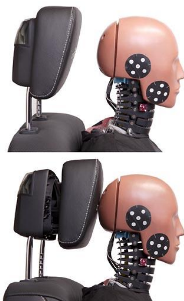
Obr. 5: Aktivní opěrka hlavy [24]
