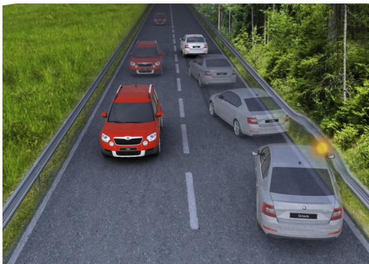
Obr. 15: Zabránění vjetí vozidla do protisměru [71]
