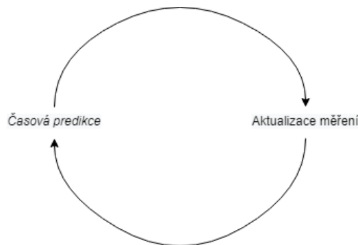
Obr. 33 Princip Kalmanova filtru
