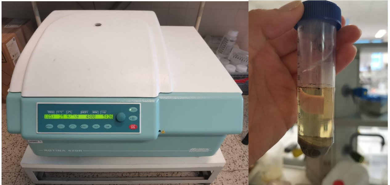
Obrázek 8: vlevo: centrifuga, Hettich ROTINA 420R (4000 ot/min, 15 min), vpravo: odstředěný vzorek
