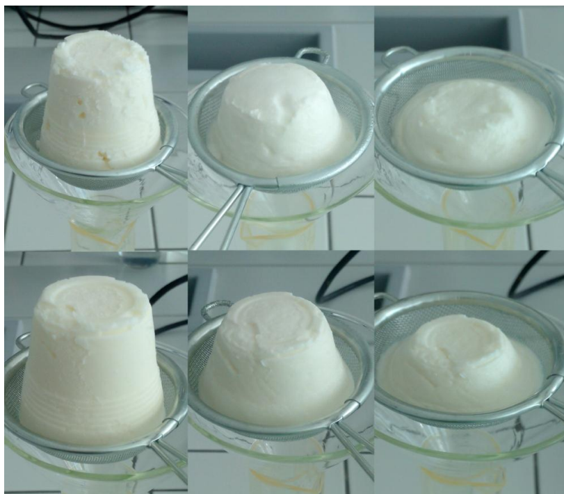
Obr. 42: WF 200, WF 400R – stav tvaru kužele po 60 a 135 min. hodnocení stability
