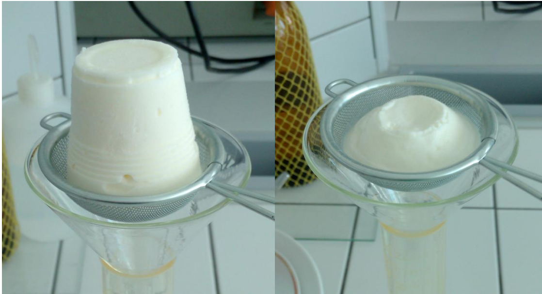
Obr. 15: Hodnocení stability – počáteční a konečná fáze po 135 minutách
