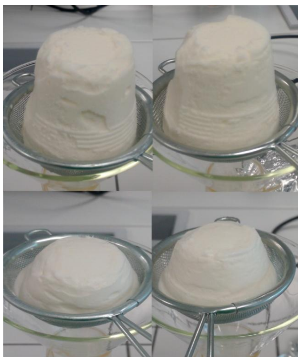
Obr. 39: WF 600/30, WF 600R – stav tvaru kužele po 60 min hodnocení stability
