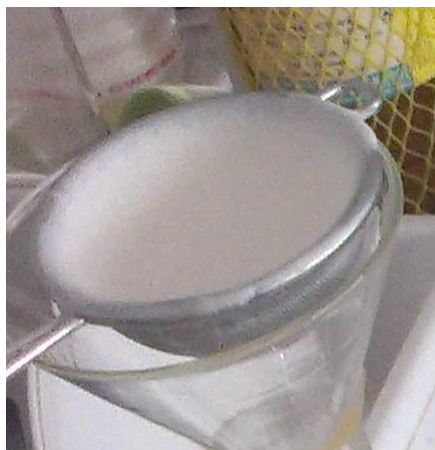
Obr. 17: Okapová zkouška – standard, stav po jedné hodině
