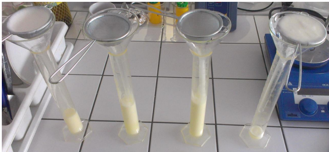
Obr. 14: Okapová zkouška – konečná fáze po 60 minutách
