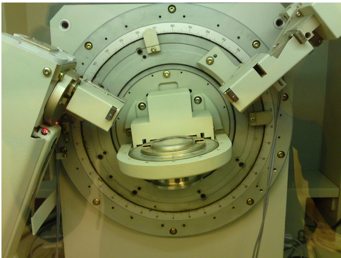
Obrázek č. 15: Detail goniometru rentgenového difraktometru Siemens D5005
