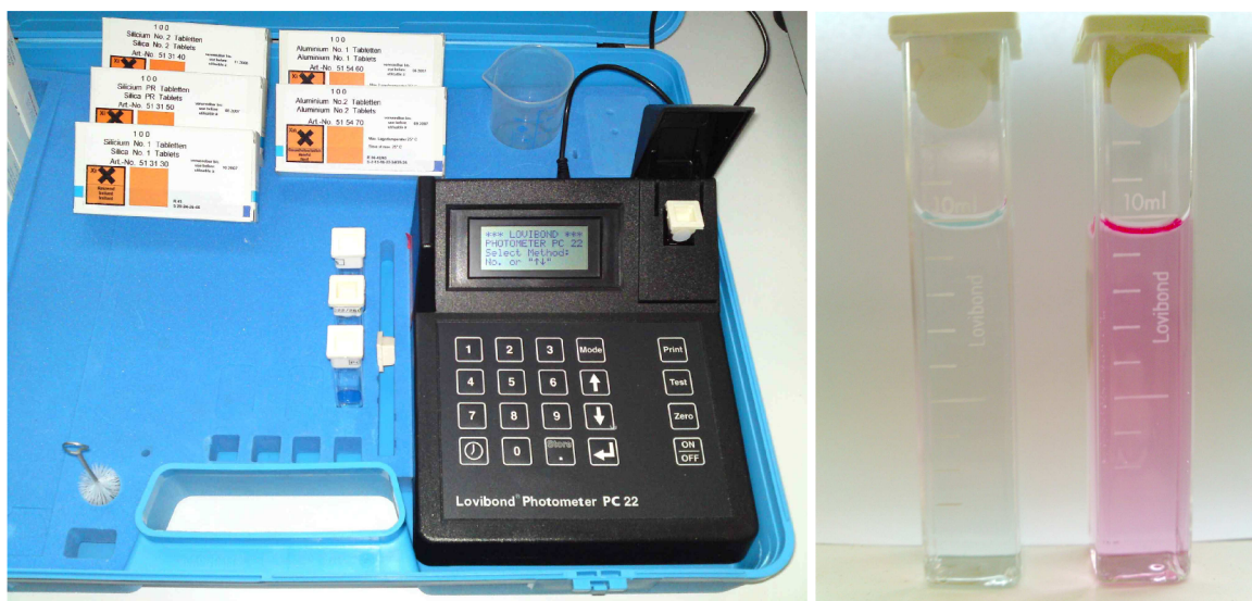
Obrázek č. 13: Fotometr Lovibond PC 22 a kyvety s indikátory na Si(vlevo) a Al
