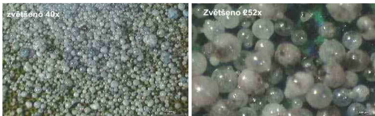
Obrázek č. 3: Cenoféry z popílku elektrárny Opatovice [7]
