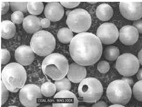
Obrázek č. 2: Morfologie cenosfér (el mikroskop) [7]
