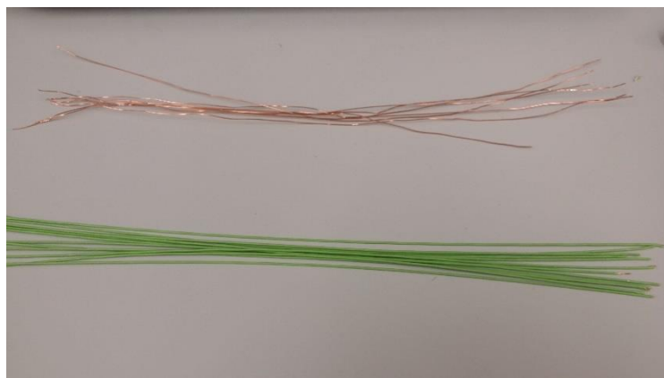
Obr. 5.14 Odporový drát, nahoře očištěný od izolace
