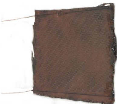
Obr. 5.18 Topný segment natřený epoxidem s mědí
